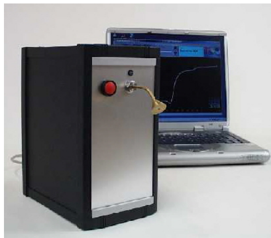
Fig. 1: Prototyp des Mikrowellen-Zeitbereichsreflektometers zur Bestimmung der Qualität von Fisch
